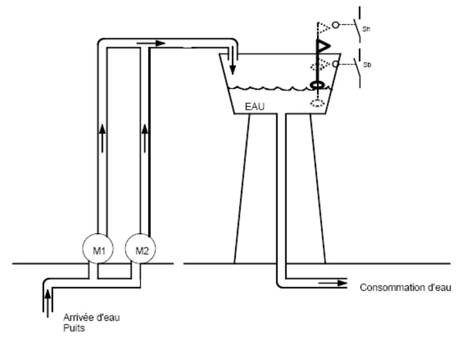
Commander 2 pompes de remplissage d'un réservoir de telle sorte que :
