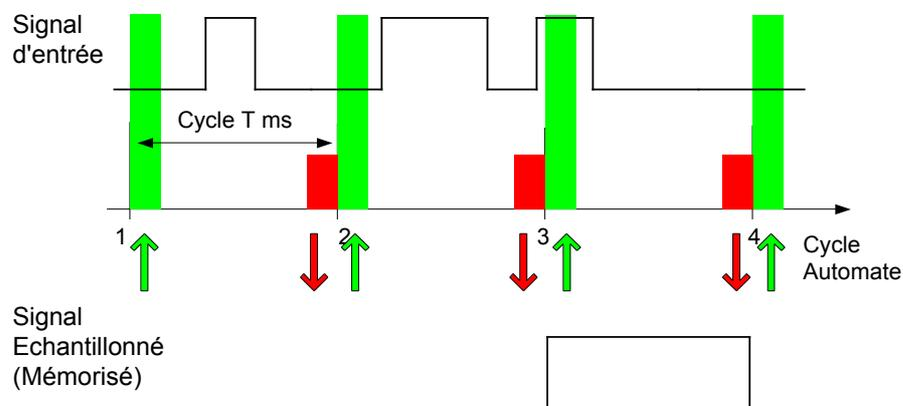
UN changement sur une entrée qui survient après le début de cycle et se termine avant le début du cycle suivant ne sera pas détecté par l'automate : **l'automate est « aveugle » durant son cycle !**
