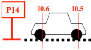
Un passage contrôle, grâce à 2 cellules (I0.5 et I0.6), les entrées et les sorties des véhicules.
