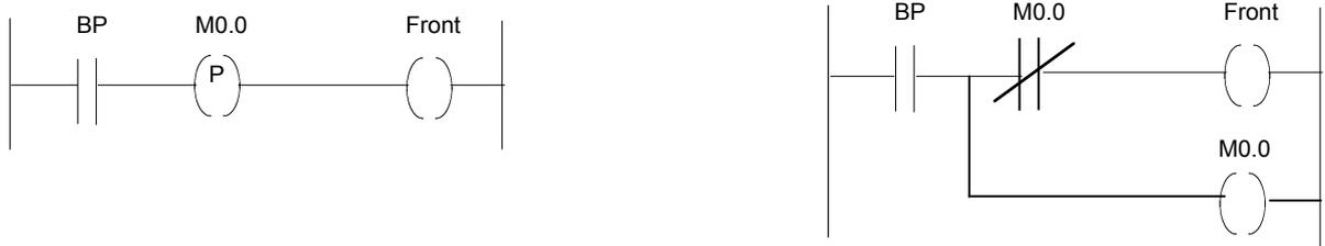
L'automate indiquera la détection d'un front montant dans une variable interne **Front** qui sera vraie pendant 1 cycle automate.
