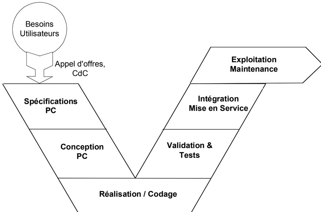
Figure 2 : Cycle en vie d'un automatisme industriel
