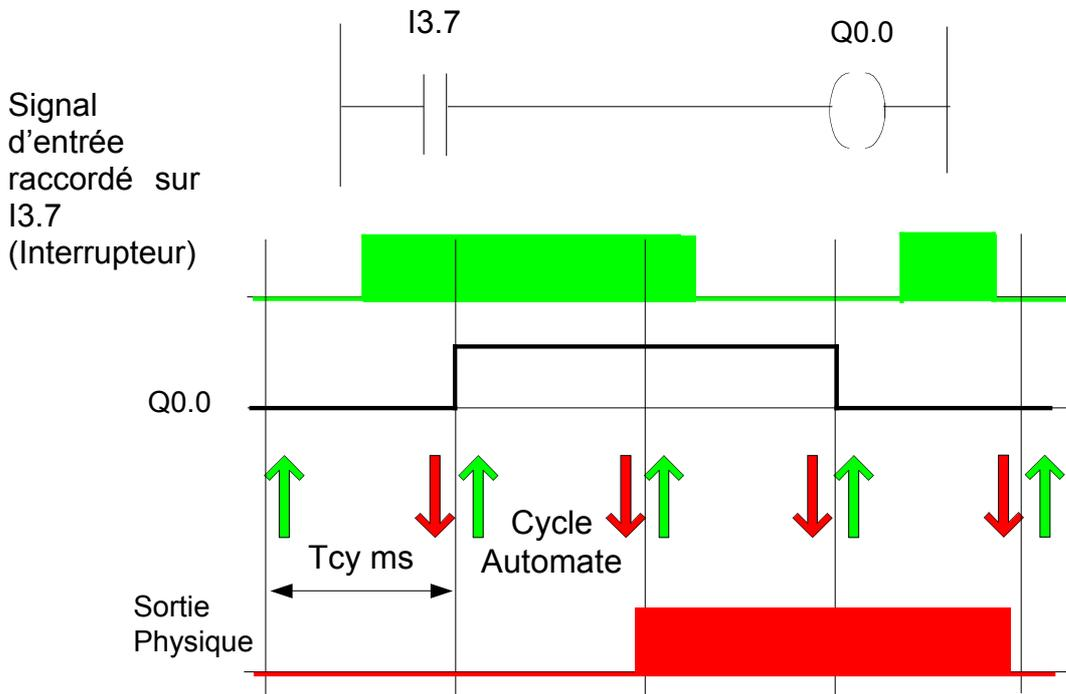
La sortie physique (par ex. une lampe) commandée par Q0.0 ne sera mise à jour qu'à la fin du cycle Automate, soit avec un décalage d'un cycle minimum (voire presque 2) sur la mise à 1 de la variable.
