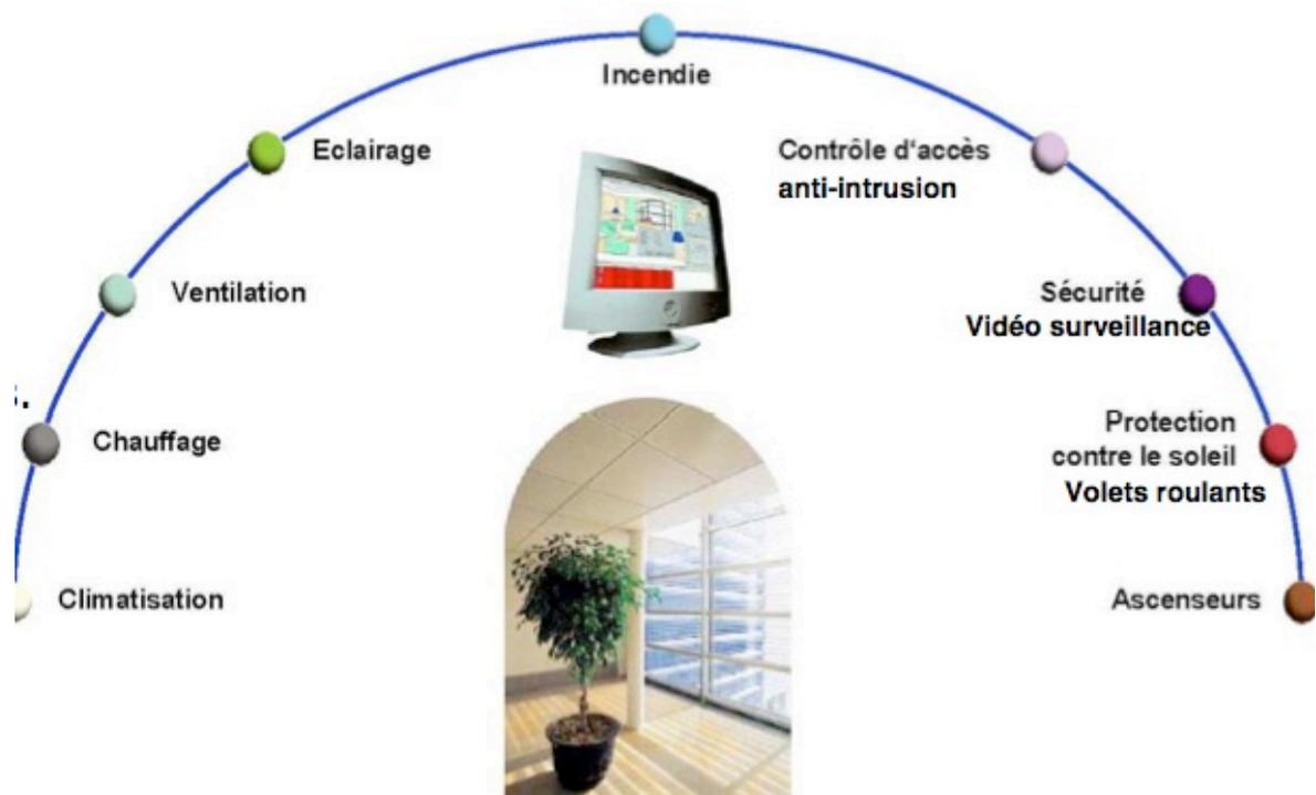
La **Gestion Technique du Bâtiment** dite GTB (ou *BMS en anglais, Building Management System*) est l'ensemble des systèmes de traitement des informations provenant d'un même site et permet de "connecter" les équipements techniques du bâtiment de confort, de chauffage, de sécurité, ..., dans les objectifs de:
